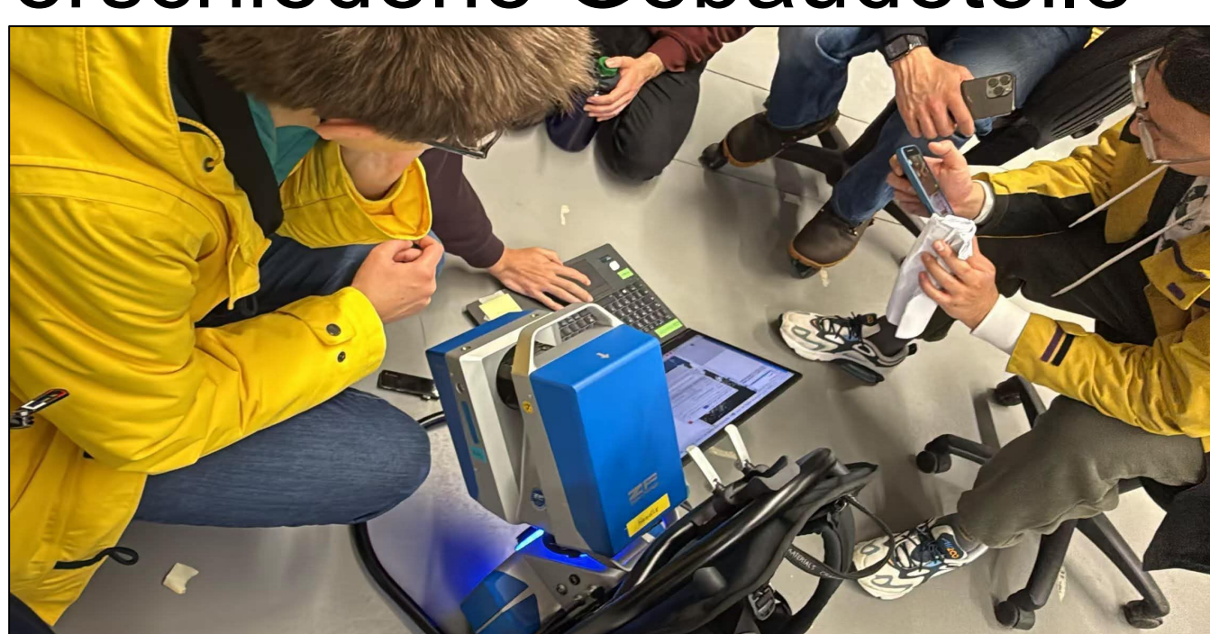
Abb. 1: Inbetriebnahme des Z+F FlexScan 22
